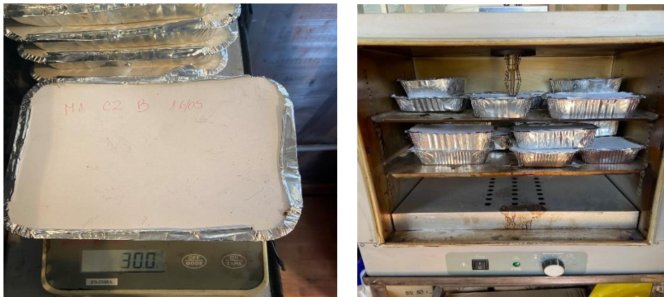
Fotografía 5. Determinación porcentaje de humedad
